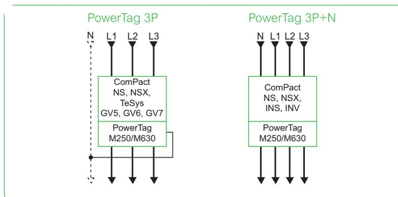
Les modules PowerTag M250/M630 sont compatibles avec Compact NSX100/160/250, Compact NSX400/630, Compact INS250-100 A à 250 A, Compact INS320/400/500/630, Compact INV100/160/200/250, Compact INV320/400/500/630, Compact NS100/160/250, Compact NS400/630, TeSys GV5, TeSys GV6 et TeSys GV7.
