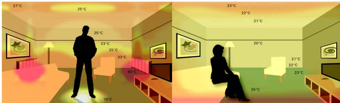
Chaleur produite par un système de chauffage classique par radiateurs. Grandes variations de température (+18 jusqu'à +26 °C) dans la pièce.
