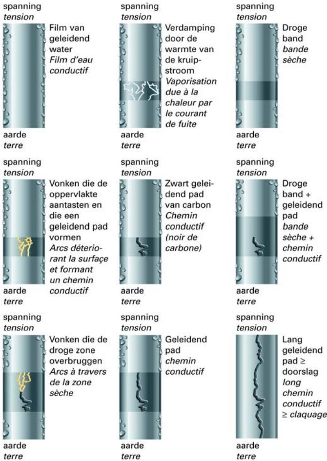
La surface d'une matière isolante, plus en particulier installée à l'extérieur, sera contaminé au fur et à mesure.
