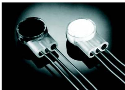
Le UR2 convient pour la jonction ou la dérivation en extrémité de 2 ou 3 fils. Leur section peut être différente. Le connecteur est rempli d'un polymère silicone (graisse) qui les rend étanches et leur assure une durée de vie importante.
