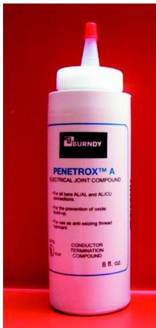
La graisse de contact type Penetrox de Burndy est appliquée sur des connexions aluminium-aluminium, aluminium-cuivre, cuivre-cuivre, acier-cuivre et acier-acier. Le but de l'application de la pâte Penetrox est: l'obtention d'une bonne connexion qui nécessite des moyens anti-corrosion.
