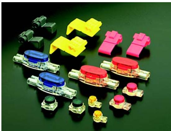
Les connecteurs Scotchlok™ ont été conçus dans le but de réaliser des connexions rapides autodénudantes au moyen d'une simple pince multiprise. Une gamme de 5 connecteurs permet de réaliser facilement tous les travaux de simple ou double dérivation, de jonctions en bout et en ligne, sur des fils de cuivre rigides ou souples de 0,5 à 4 mm<sup>2</sup>.
