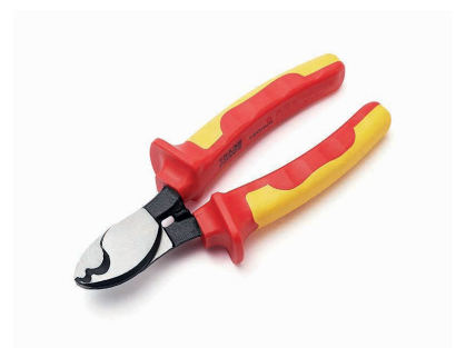
REF 2000 1600003 KABELKNIPTANG VDE 160 MM • Geschikt voor CU & AL-kabel, één- en meerdrads • Snijcapaciteit koperdraad: 22 mm 2 • Niet geschikt voor staal- en hardgetrokken koperdraad • Knipt glad zonder vervorming • Handige éénhandsbediening
