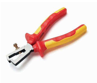
REF 2000 21090006 STRIPTANG VDE 160 MM • Capaciteit Ø 0,5-2,5 mm / 0,2-5 mm 2
