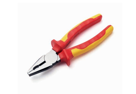
REF 2000 8360004 COMBINATIETANG VDE 180 MM • Chroom-vanadiumstaal, gesmeed en gehard • Knipt glad • Goede grip voor plat en rond materiaal
