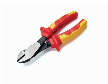
REF 2000 1650003 KRACHT-ZIJKNIPTANG VDE 180 MM • Snijlengte 25 mm • Snijcapaciteit harde draad: Ø 1.8 mm
