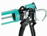
Le réglage **anti-goutte** est destiné à l'application d'acrylique et silicone qui s'écoulent rapidement. Désactivez l'**anti-goutte** pour les adhésifs de construction et polyuréthanes froids qui s'écoulent plus lentement.
